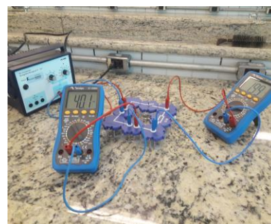
Figura 2. Experimento da Lei de Ohm.
